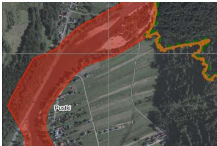
Wyrys z zał. nr 2 do uchwały ws. PMOChK ze wskazaną strefą zakazu budowy nowych obiektów budowlanych od linii rzek i zbiorników wodnych
